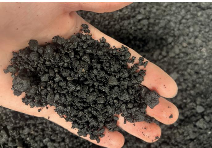
Die Verarbeitung ist wetterunabhängig bei -30 °C bis +70 °C möglich, ohne Erhitzen oder Primer. Feuchte Untergründe sind kein Problem. Vor der Verarbeitung wird das Material gründlich durchmischt, um eine gleichmäßige Struktur zu gewährleisten. Es wird direkt aus der Verpackung ohne Zusatz von Wasser eingebaut. Dabei ist ein Überbau von ca. 20% der Reparaturfläche empfehlenswert, um einen ebenen Übergang zu gewährleisten.
